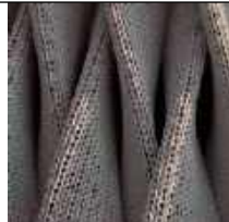
tissage en tube autour d'une âme en caoutchouc material wrapped around a rubber core tejido en tubo alrededor de un alma de caucho
